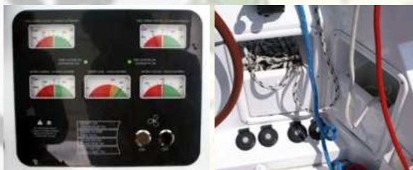
Tot queda reenviat fins el lloc de comandament. Una persona es perfectament capaç de menar el vaixell. El panell elèctric indica mitjançant amperímetres analògics l'estat actual dels consums i càrrega de cada motor. Instal·lats sota el timó i a l'alçada dels peus hi ha els comandaments dels cabrestants elèctrics que ajusten les escotes i drisses sense cap esforç. Sobre ells s'han disposat caixes per organitzar els caps que no treballen.
